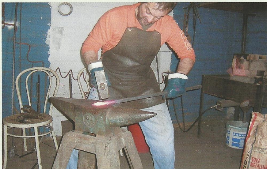
EPHESTUS. Vincenzo Pastorelli al lavoro nella sua fucina durante la fabbricazione della copia della spada gallica riprodotta su modello di quella rinvenuta nella tomba 107 di Monte Bibele.
